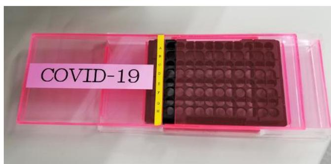
注) 前頁のようなカバーを利用した96ウェルプレートへのサンプルの手分注は、ウェルの間隔が近接しているためコンタミネーションのリスクを排除できない。対策として、96プレートフォーマットに配置できるマイクロチューブに、バーコード照合しながら1対1で手分注し、元検体ID-マイクロチューブID-プレートID-ウェルポジションの情報を連結させた上で、自動分注機を用いて次工程の96ウェルプレートに分注させることも有効である。
