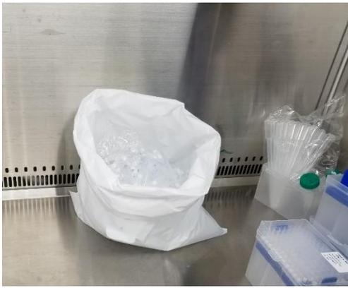
チップ廃棄袋の使用例。テーブル面に直置きしているが、倒れてチップが溢れ出る恐れがあるため、薦められない（左写真）。
